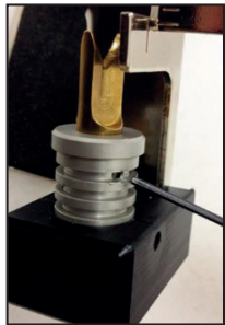
3. Die Stellschraube mittels kleinstem mitgeliefertem Imbusschlüssel lösen.
